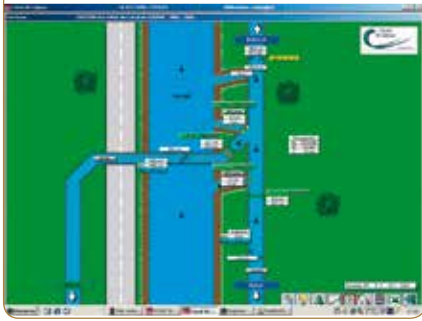
Écran du logiciel superviseur SCADA du canal de Gignac Source : Revue SET - numéro 11 - 2013
